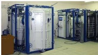
Серия напылительных установок ВАТТ 900 для различных задач нанесения декоративных и функциональных покрытий. В дальнейшем на ее базе создана серия установок ВАТТ 700.
