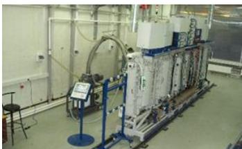
Первые **проходные** вакуумные установки ВАТТ 600x1200М-ЭД и ВАТТ 600-6 ИМД.
