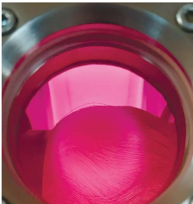
**Рисунок 6** – Газовый разряд у поверхности полволоконных мембран МЭ в среде воздуха
